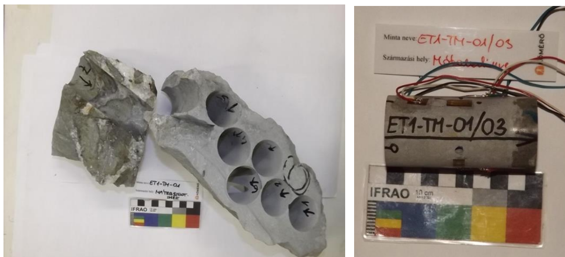
1.ábra a: A föld alatti laboratórium térségéből mintázott andezit kőzettömb a minták kifűrése után; b: A kiértékeléshez használt 01/03 sz. szabványos minta a mérőbéllyegekkel.
